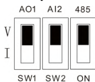
Рис. 3-22 Настройка двухпозиционного переключателя
