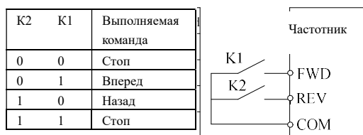
Рис.6-13 Двухпроводной режим управления 1
